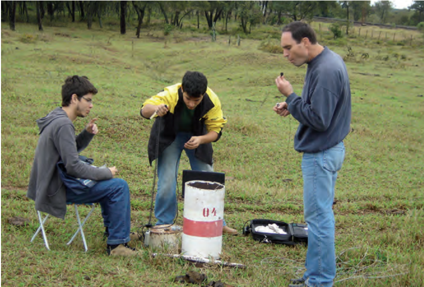
Medição do nível das águas subterrâneas em monitoramento instalado na zona de afloramento do Aquífero Guarani.
