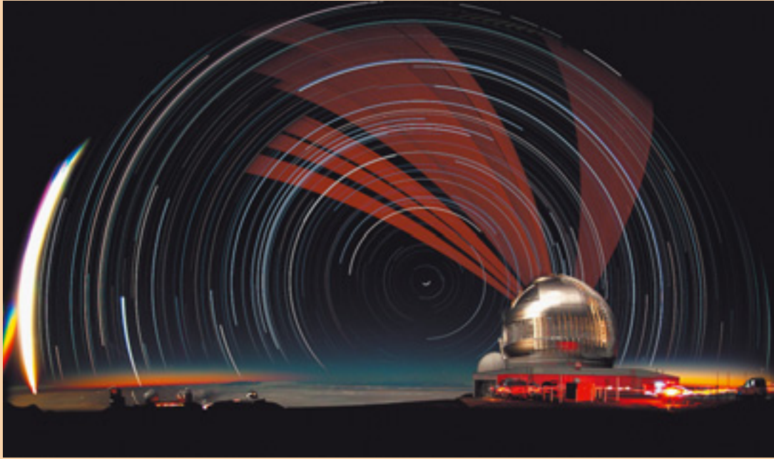
A cúpula do Gemini Norte em foto de longa exposição, mostrando trilhas de estrelas e a propagação de uma estrela artificial a laser, criada pelo sistema de óptica adaptativa, 2010 FONTE: GEMINI OBSERVATORY/ JOY POLLARD
