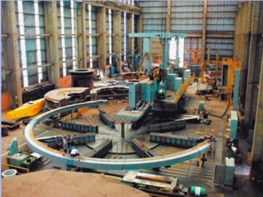
Estrutura de aço com 20m de diâmetro que forma a base da cúpula do SOAR, durante sua fabricação em uma metalúrgica brasileira, 2000 FONTE: ARQUIVO HISTÓRICO DO LNA
