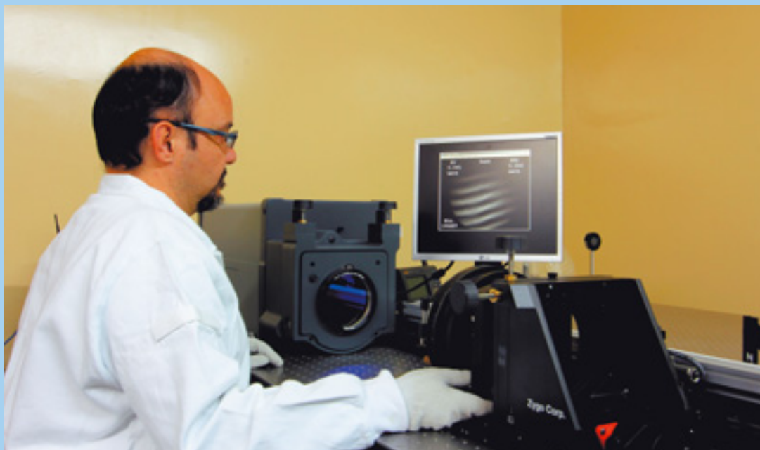
Fotografia do Laboratório de Metrologia Óptica do LNA, mostrando em destaque aparelho que usa interferometria para caracterizar lentes e outros componentes óticos
