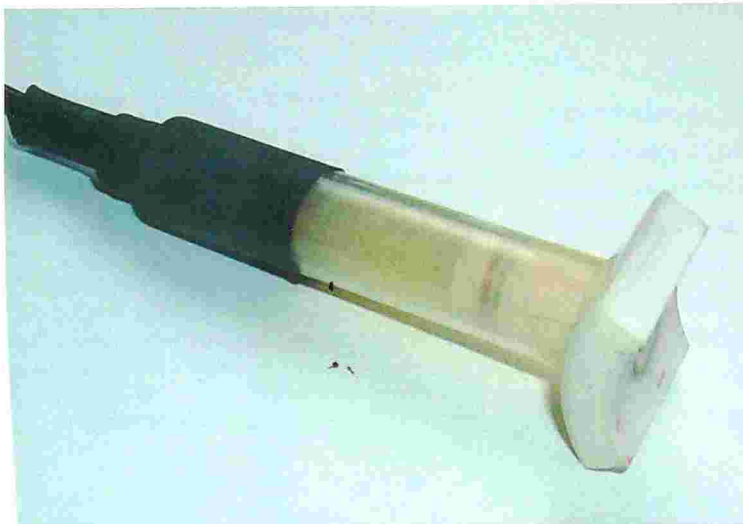
Sonda projetada e construída no CDTN para verificar a integridade do revestimento de combustíveis nucleares em reatores de pesquisa
