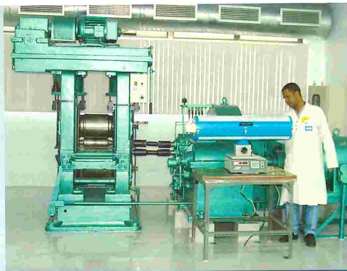
Processo de laminação do combustível nuclear tipo placa
