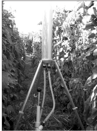
Figura 9.4 Instalação de um permeâmetro de Guelph no campo
