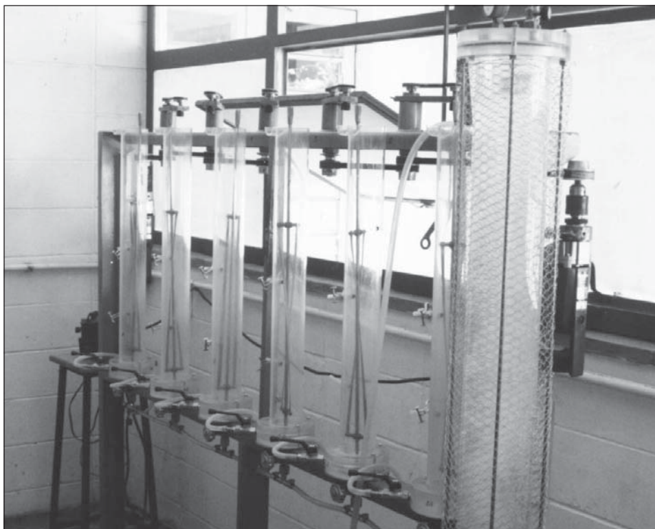
Figura 3.5 Fotografia ilustrando da instalação de flotação por ar dissolvido em escala de laboratório (flotateste).
