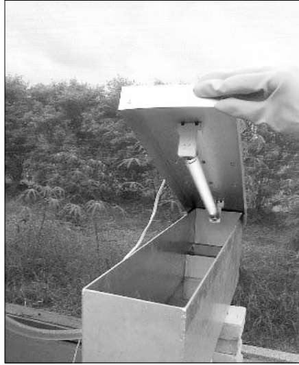
Figura 6.30 Reator UV do tipo canal com lâmpadas emersas.
