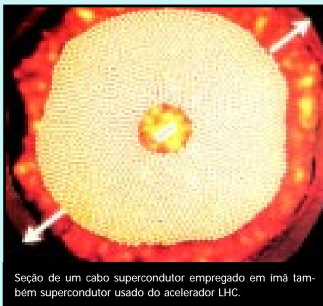
Seção de um cabo supercondutor empregado em ímã também supercondutor usado do acelerador LHC.
