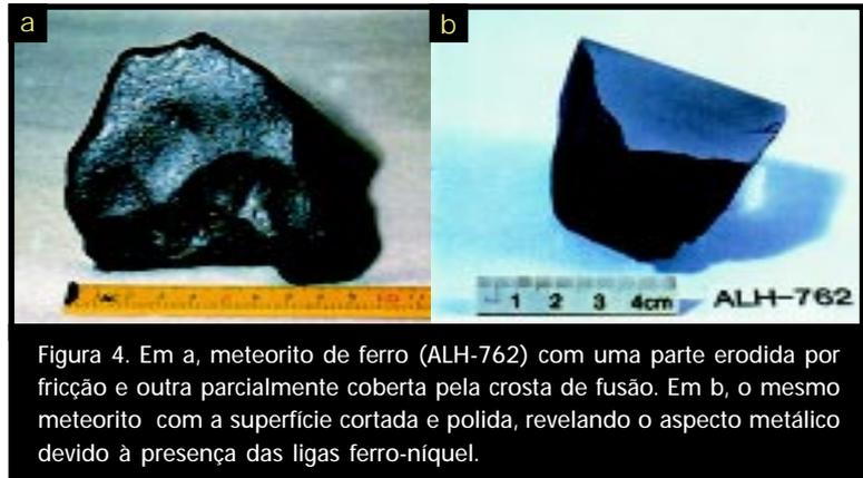
Figura 4. Em a, meteorito de ferro (ALH-762) com uma parte erodida por fricção e outra parcialmente coberta pela crosta de fusão. Em b, o mesmo meteorito com a superfície cortada e polida, revelando o aspecto metálico devido à presença das ligas ferro-níquel.
