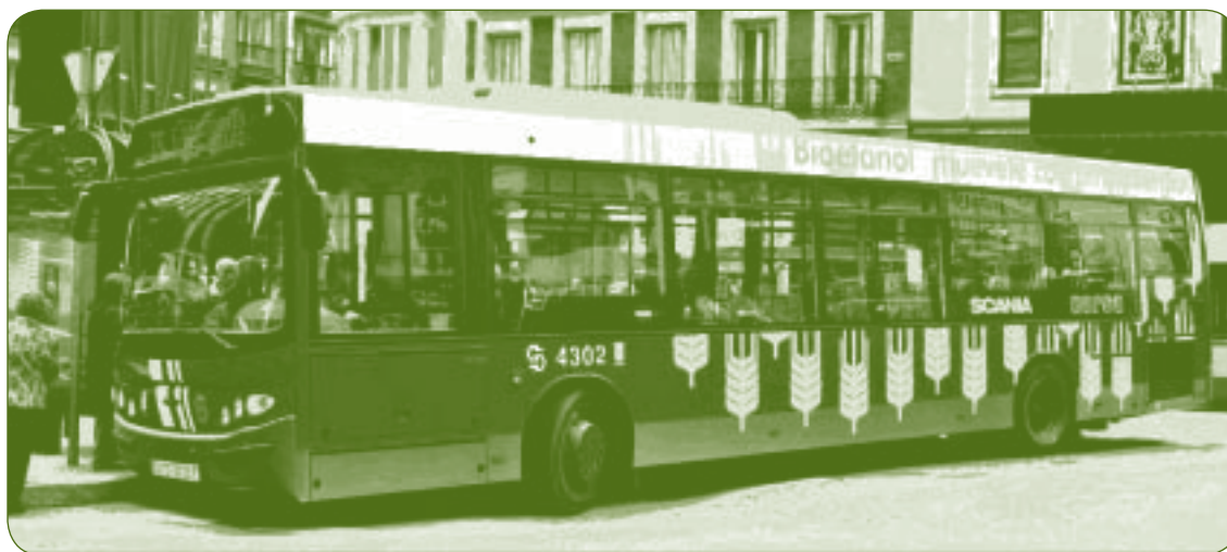
Ônibus com motor ciclo Diesel a etanol hidratado em Madri.
