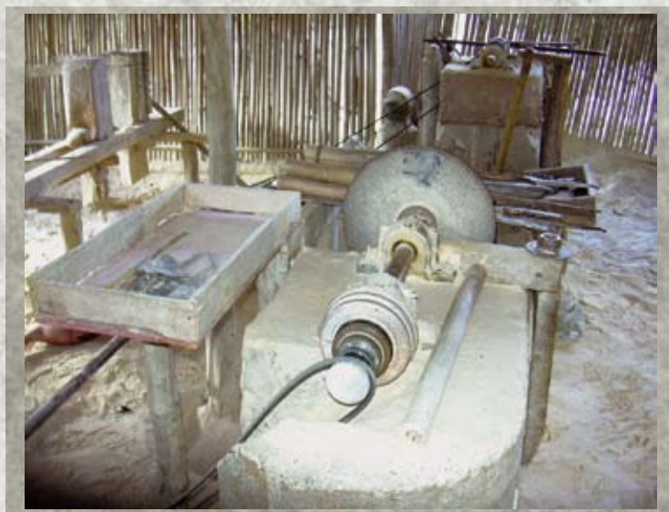
Imagem 19 - Torno elétrico para o trabalho da pedra-sabão. Ver página 172. (Foto: Equipe PROSUL – CETEM/MCT)
