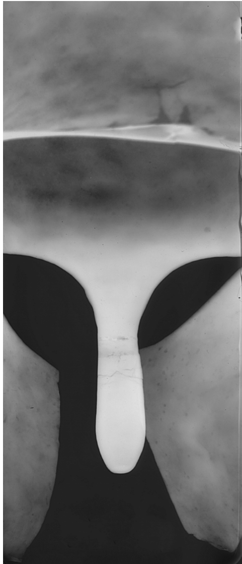
Fig. 4.- Protector nasal en el que se aprecia, delimitado por dos trazos, el cordón de soldadura de reparación.
