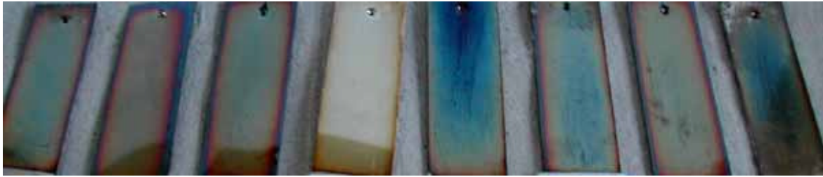
Fig. 3 – Plaquetas de prata expostas em ambientes com diferentes agressividade: a coloração é função da espessura da camada oxidada, evoluindo do amarelo claro até o preto.
