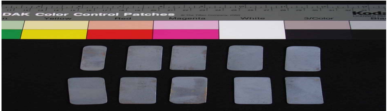
Imagen. 4. Apariencia de las probetas doradas, luego del proceso de corrosión.
