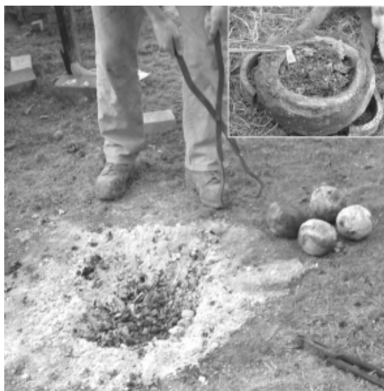
Figura 2: Simulação da técnica de cementação para a purificação de ouro e de prata: (1) alguns dos cadinhos com os diferentes cimentos; (2) preparação dos cadinhos para o tratamento térmico; (3) tratamento térmico e abertura de um cadinho após cozimento.
