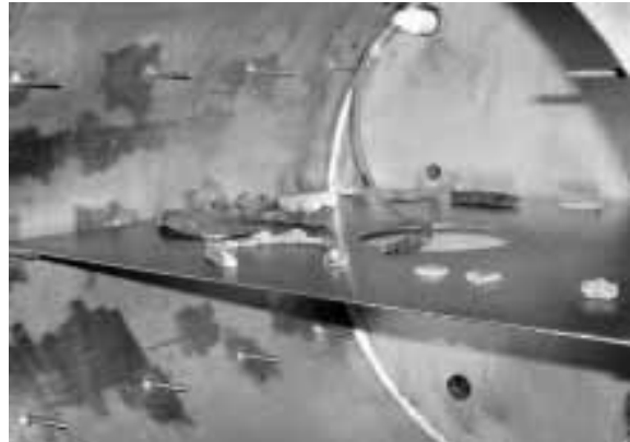
Fig.8. Piezas en el interior del reactor de Plasma de hidrógeno (IGS)
