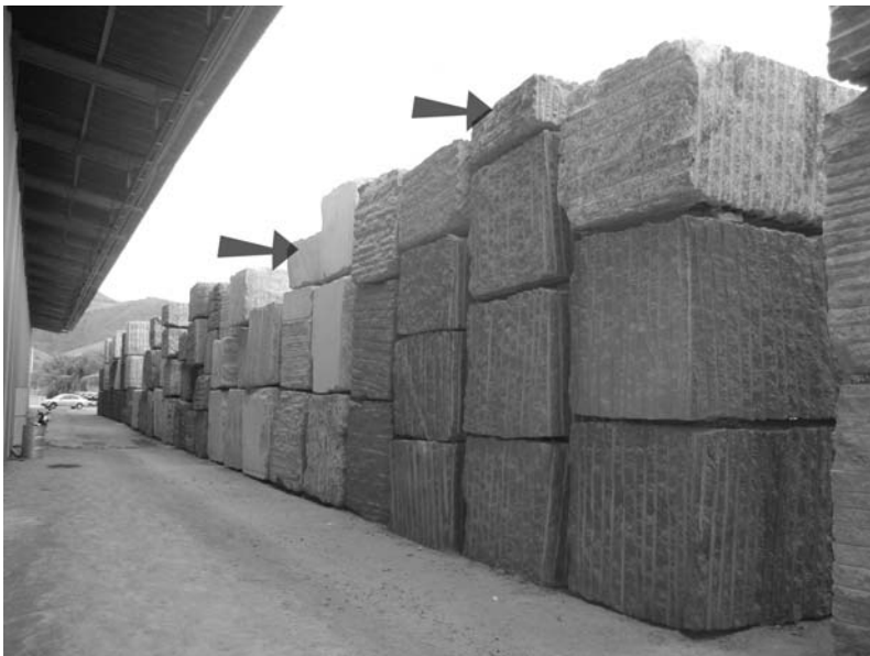
Foto 04 – Blocos e “interas” - tamanhos diversos. (foto do autor)
