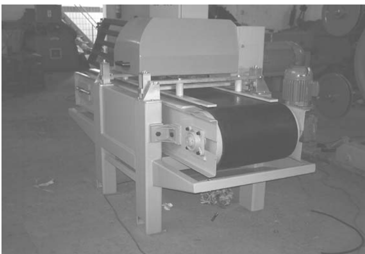
Figura 3: Máquina responsável pela produção de artefatos minerais, utilizando rejeitos da lavra e beneficiamento
