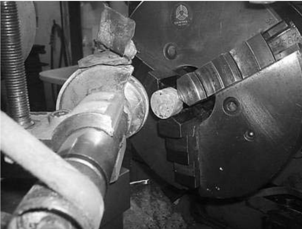
Figura 6: Retificação de um corpo-de-prova no torno mecânico com retifica
