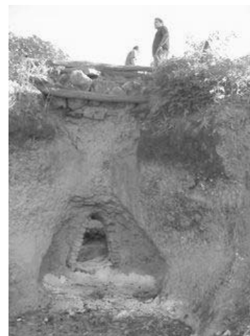
Figuras 2 e 3: Extração e calcinação do calcário metamórfico
