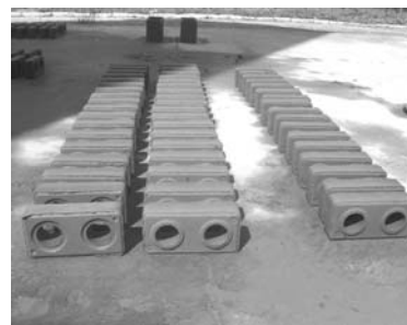
Figura 12: Tijolo de solo-cimento com lama abrasiva
