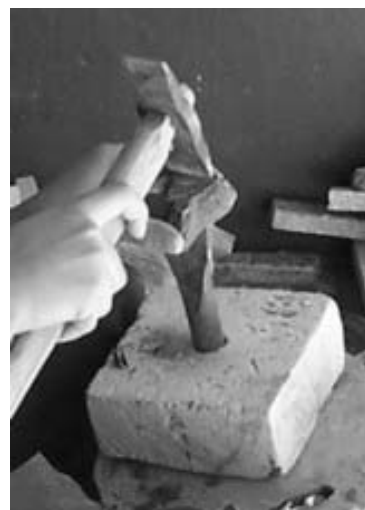
Figura 2: Utilização da martelina e do tagliolo na geração de tesselas.
