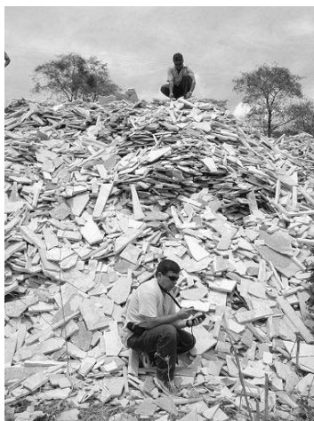
Figura 1: Pilha de rejeitos da Pedra Cariri
