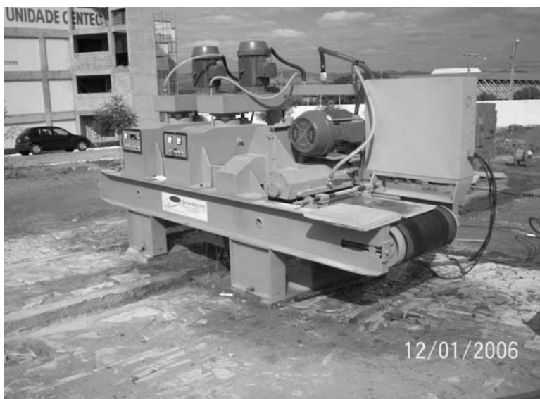
Figura 1: Máquina Calibradora, ajuste de espessura dos ladrilhos
