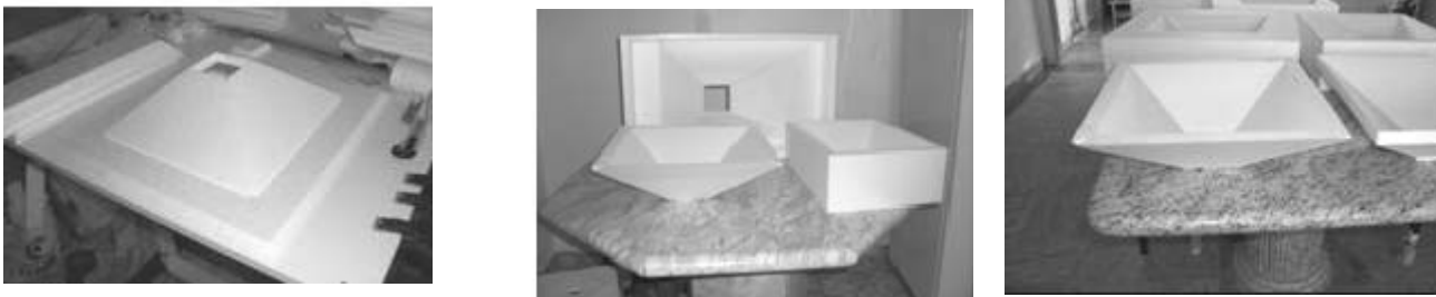
Ilustração 3: desenvolvimento de mock-ups em isopor para avaliação estética, ergonômica e funcional
