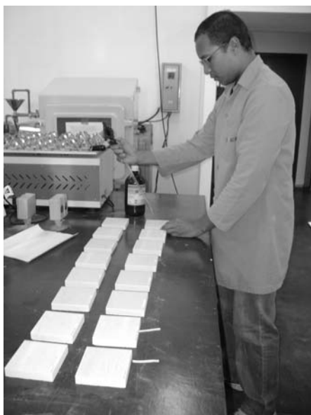
Figura 3.1: Procedimento do ensaio de ataque químico.
