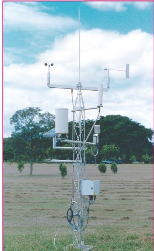
Figura 5.27. Plataforma de Coleta de Dados.
