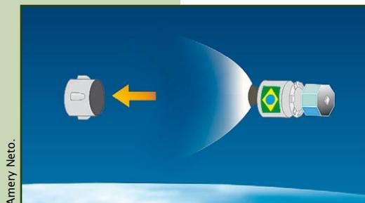
Figura 4.61. Separação da Baía de Equipamentos do VLS-1.
