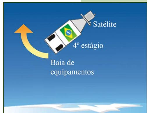
Figura 4.59. Manobra de basculamento do VLS-1.
