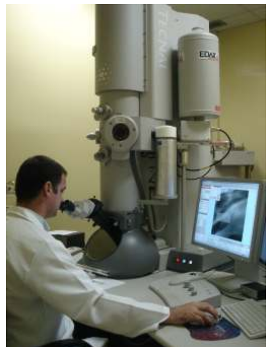
Microscópio eletrônico de transmissão FEI, modelo Tecnai 20
