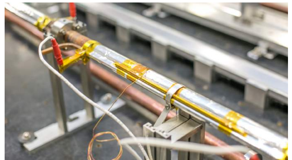
Detalhe do dispositivo para baking das câmaras de vácuo para o anel de armazenamento do Sirius, desenvolvido pela empresa parceira EXA-M
