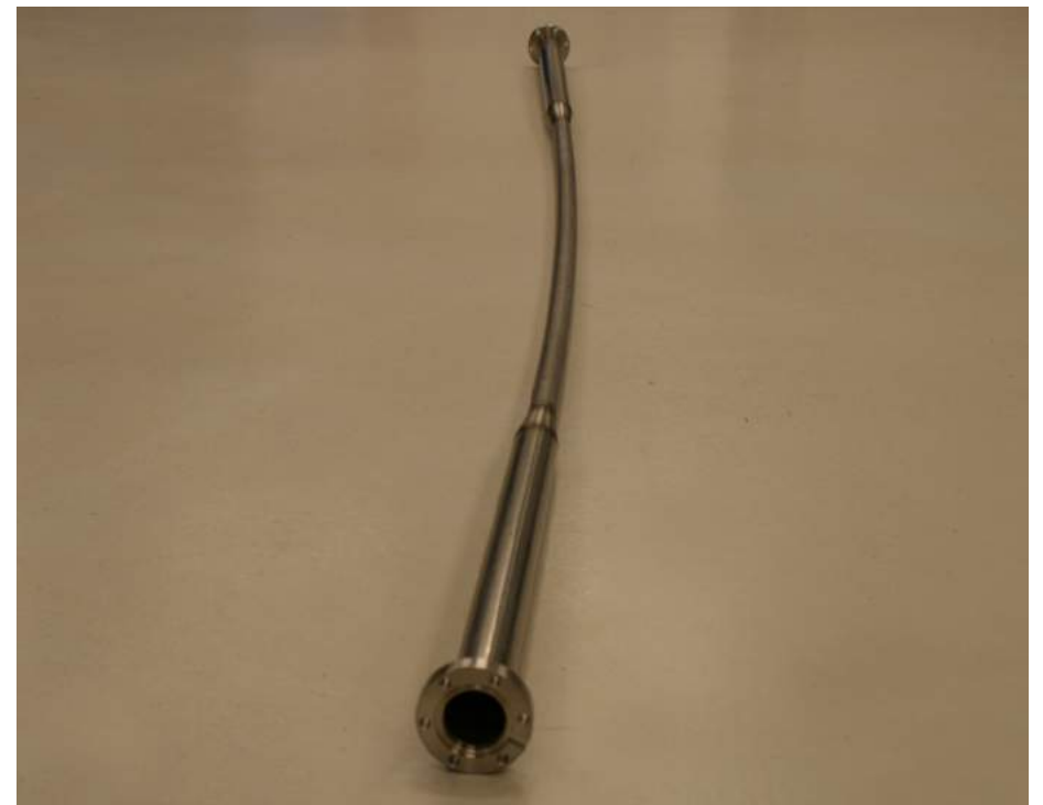
Protótipo de câmara de vácuo do Booster, desenvolvido em parceria com a empresa FCA Brasil, parceira do projeto Sirius
