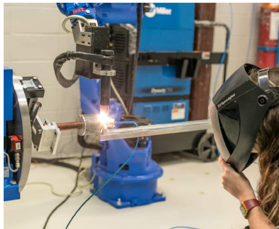
Teste de processo de solda de cobre para as câmaras de vácuo do anel de armazenamento
