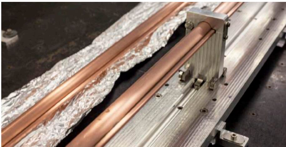
Protótipo da câmara de vácuo do anel de armazenamento, desenvolvido com material da Termomecânica, parceira do projeto Sirius
