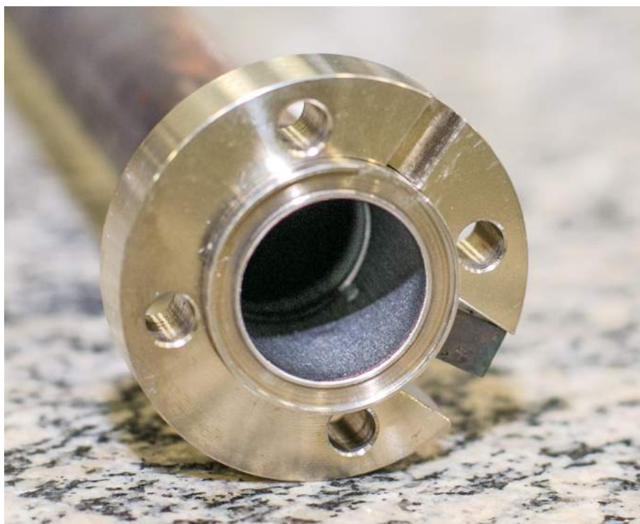
Filme NEG depositado na parede interna de um segmento da câmara de vácuo projetada para o Sirius
