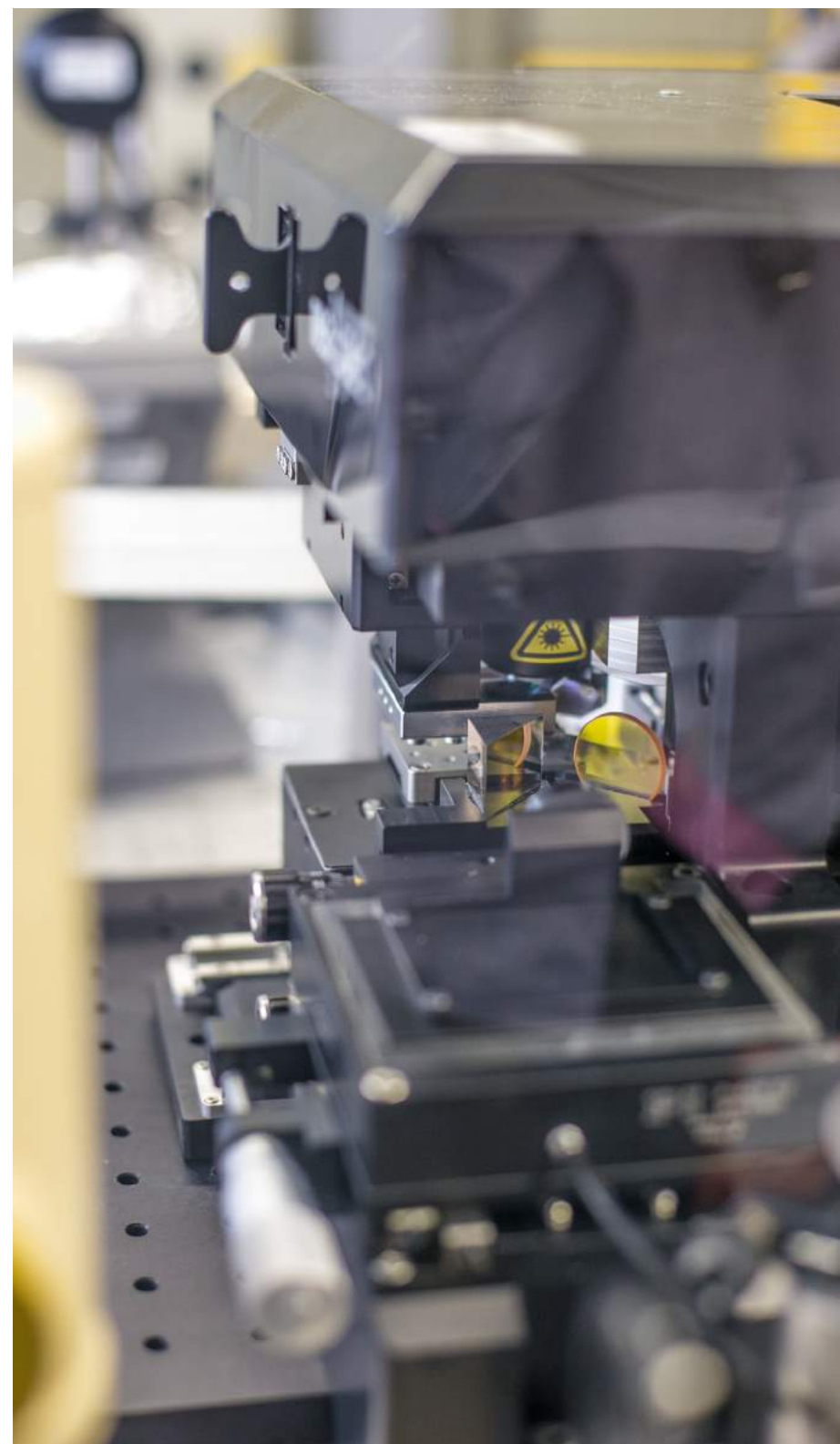
Microscópio de a-SNOM para medidas de nano-FTIR, atualmente em comissionamento no anel UVX
