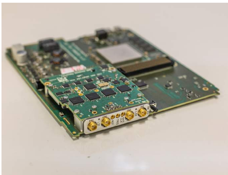
Placa eletrônica digital para medição de posicionamento, desenvolvida no LNLS
