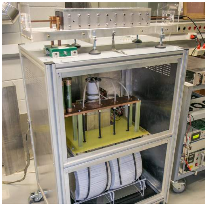
Protótipo do kicker de ejeção do Booster, fabricado no LNLS
