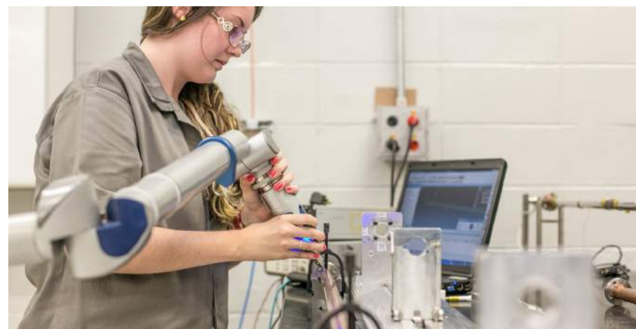
Colaboradora do LNLS faz o controle dimensional de uma peça usando um sistema de medição por contato disponível no Laboratório de Vácuo
