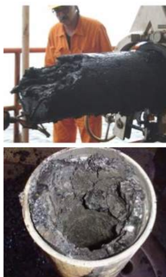
Figura 11 - Asfaltenos, conhecidos como “colesterol do petróleo”, tendem a precipitar e se depositar em superfícies, causando o bloqueio de tubulações de poços de exploração de petróleo
