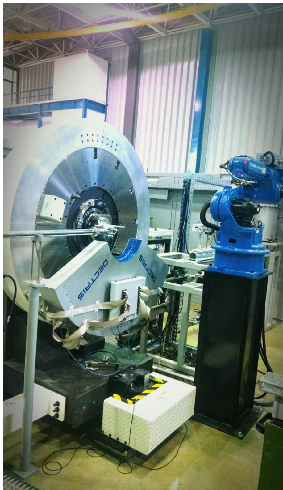
Estação experimental para difração de pó hoje instalada no anel UVX e que será empregada na linha Paineira
