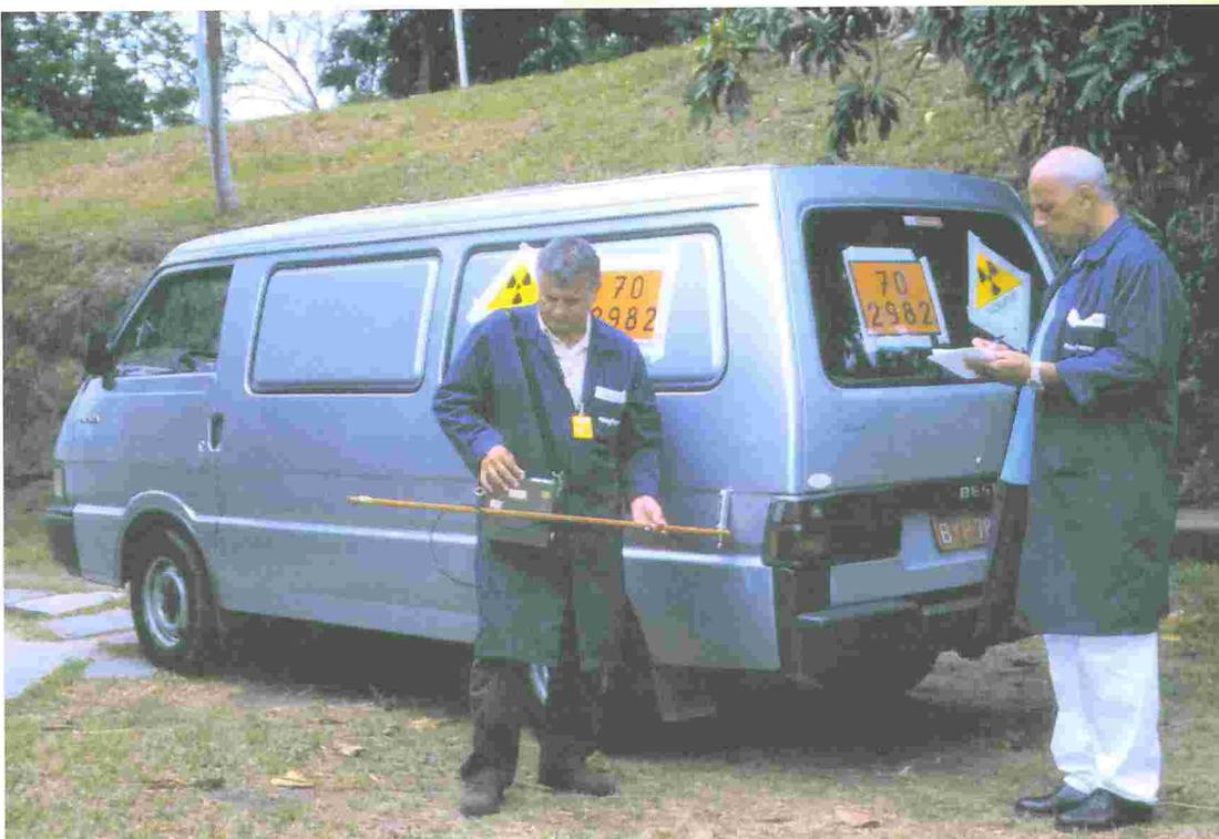
Controle do nível de radiação em transporte de radiofármacos
