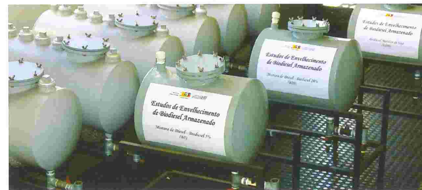
O biodiesel é armazenado em tanques, em uma das etapas dos estudos de armazenamento.
