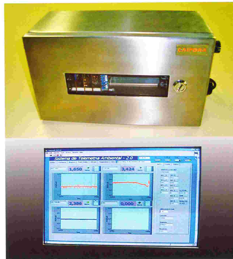
Acima, o registrador do Caipora, que guarda os dados do meio ambiente e os transmite por telemetria a um computador.
