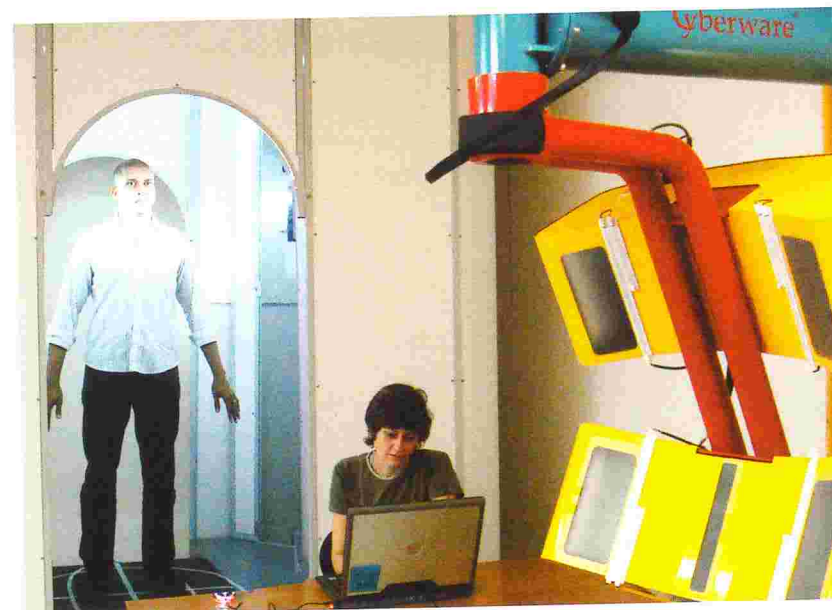
Scanner tridimensional a laser captura imagem humana para uso em projeto de ergonomia voltado para a indústria de óleo e gás.
