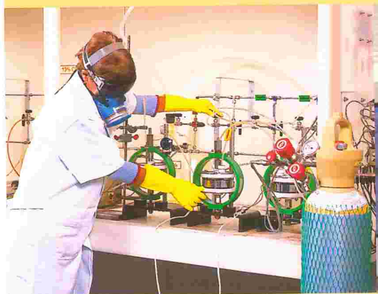
Aços especiais são testados no Laboratório de H_2S , CO_2 e Corrosividade.
