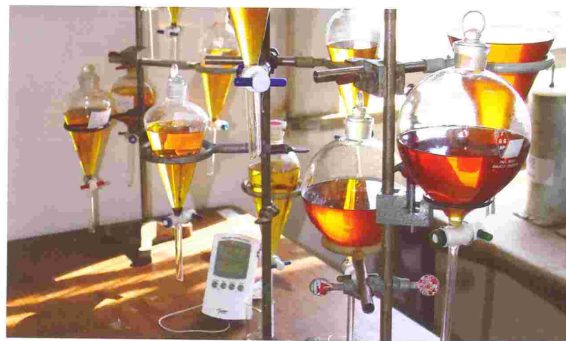
Biocombustíveis: testes de armazenamento, no Laboratório de Corrosão e Proteção.
