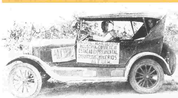
Agosto de 1925 Automóvel Ford, especialmente preparado na Estação Experimental de Combustíveis e Minérios (hoje Instituto Nacional de Tecnologia), que fez os percursos Rio S. Paulo, Rio Barra do Piraty e Rio Petropolis, alimentado com álcool de 70 Graus e dirigido pelo engenheiro Souza Mattos.
