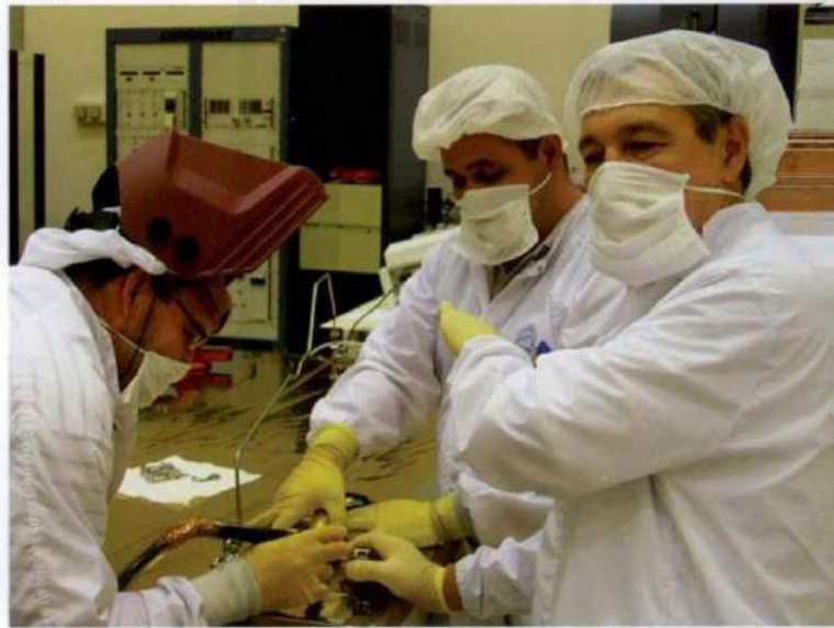
Trabalho minucioso: técnicos soldam a junta de propulsão do satélite. Precision assembly: technicians weld the satellite propulsion flange.
