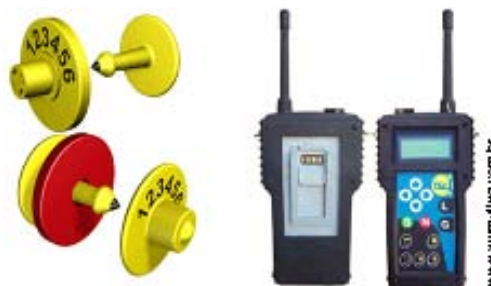
Ilustração 5. Brinco eletrônico e leitor eletrônico digital AnimallTag KT 35/1 utilizados durante o experimento.
