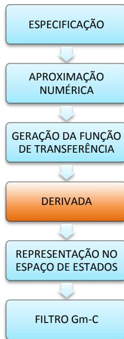
Figura 5. 6 - Fluxo de projeto para desenvolvimento do Gerador de Pulsos UWB modificado para geração do pulso PSWF de segunda ordem.
