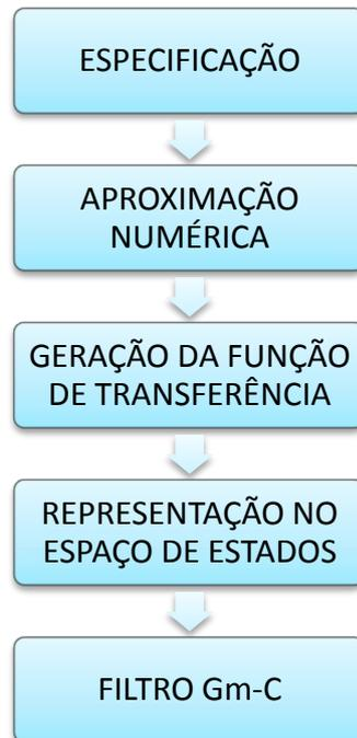
Figura 5. 1 - Fluxo de projeto para desenvolvimento do Gerador de Pulsos UWB.
