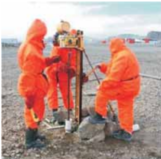
Figura 3. Coleta de permafrost realizada à profundidade de 9m na Ilha Rei George, para análise microbiológica, realizada em cooperação com pesquisadores russos.
