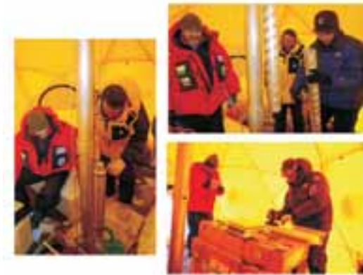
Foto 3. Perfuração e obtenção de um testemunho de gelo. A seqüência mostra o manejo da perfuradora e o empacotamento de uma seção de 1m. Contribuição de Jefferson Cárdua Simões.
