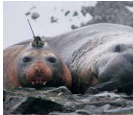
Figura 1. Fêmea de elefante-marinho equipada com um mini-CTD, unidade fabricada pela SMRU, Universidade de St. Andrews, Escócia.
