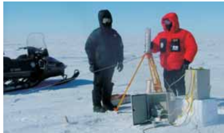
Foto 6. Pesquisadores da expedição ao montes Patriot (2008/2009) examinam o equipamento usado para amostrar micropartículas atmosféricas. Contribuição de Jefferson Cárdua Simões.
