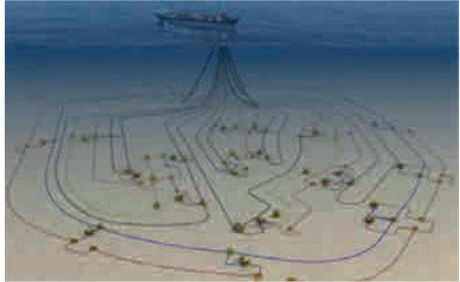
**Figura 18** – Representação esquemática da interligação das linhas de um FPSO aos poços. Fonte: EIA/Rima Etapa 2
