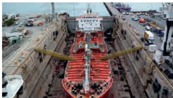
**Figura 1** – Aspecto geral de um dique seco drenado possibilitando a realização de operações (construção, limpeza, reparo e pintura) - <http://worldmaritimeneews.com/archives/178799/spotted-cape-towns-dry-dock-gets-busy/>
