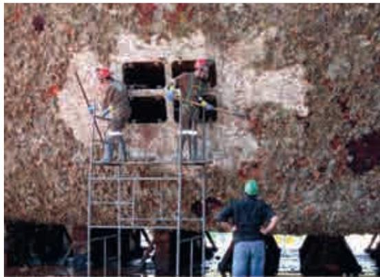
Figura 4 – Remoção manual em embarcação mantida em dique-seco.
