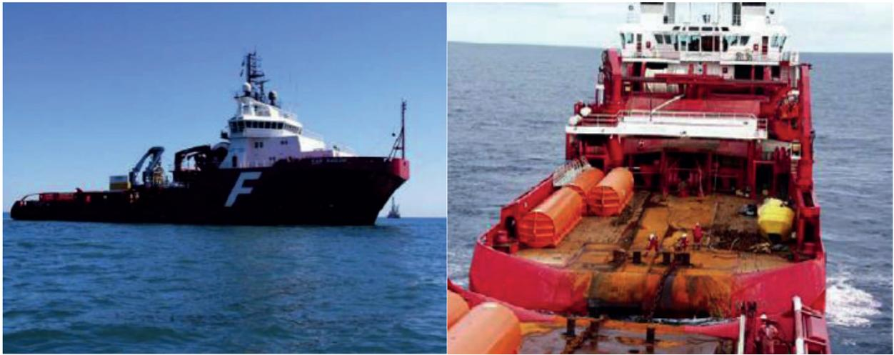
Figura 19 – Embarcações do tipo AHTS.
