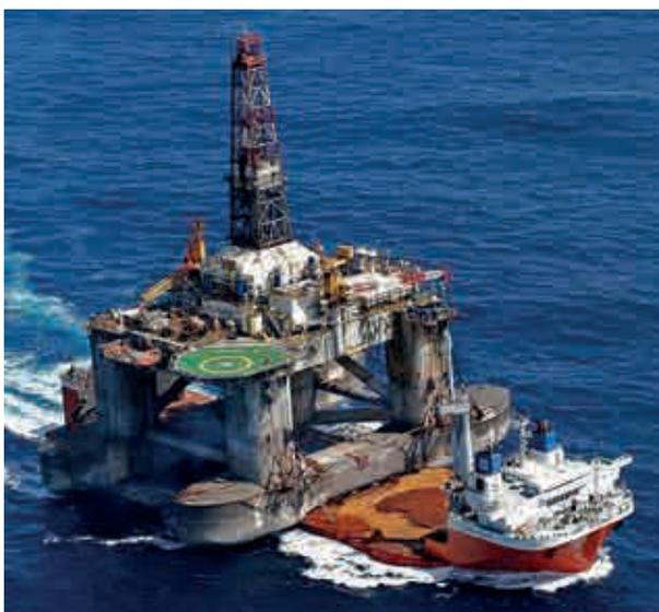
Figura 6a – Uma sonda semissubmersíveis sendo transportada por um HLV (MAF, 2009).
