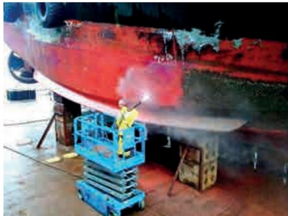
**Figura 5** – Hidrojateamento em casco de embarcação.
