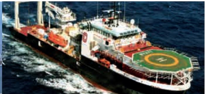
Figura 22 – Embarcação do tipo DSV
