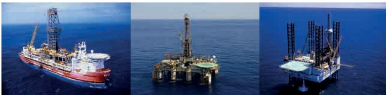
Figura 11 – Exemplos de tipos de sondas: Navio-Sonda, Semissubmersíveis e Autoelevatórias.
