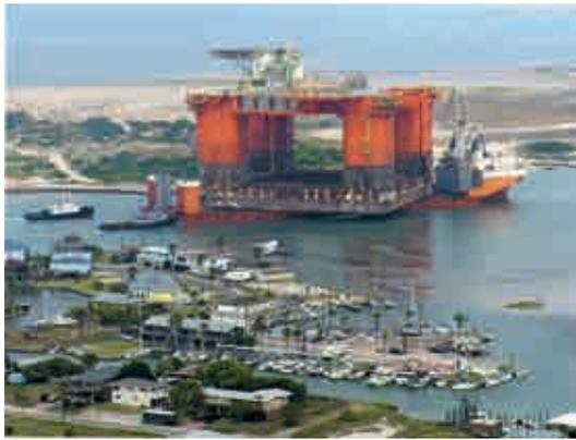
**Figura 6b** – Transporte de plataforma por um HLV
