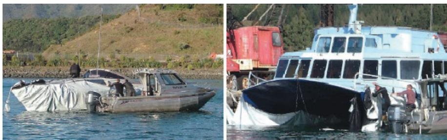
**Figura 21** – Embarcações encapsuladas em Queen Charlotte Sound na Nova Zelândia, como parte de um programa de erradicação da ascídia *Didemnum vexillum*.
