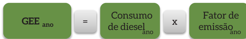
Figura 91 – Metodologia para a Projeção das Emissões no Transporte de Carga Ferroviário
