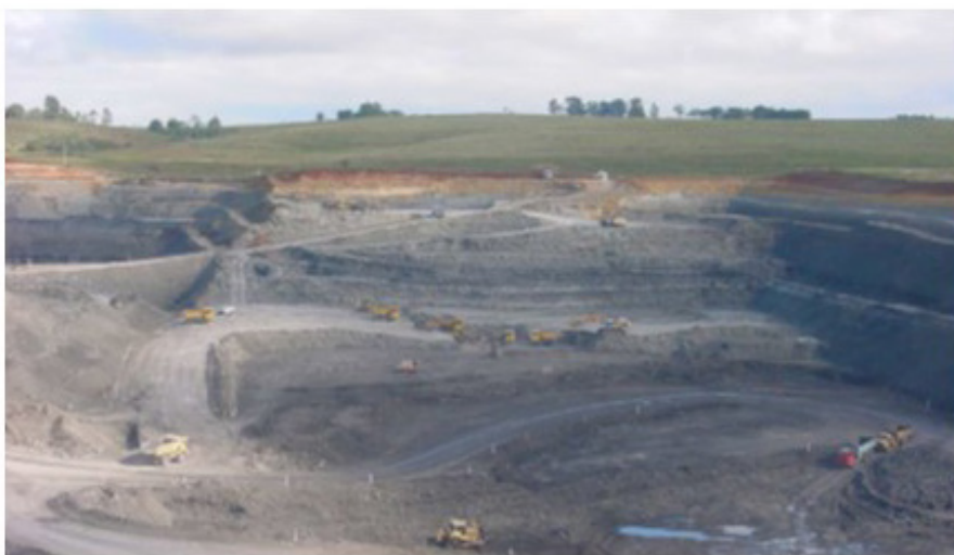
Figura 4 – Lavra em Tiras em Mina de Carvão da Copelmi Mineração Ltda., Mina do Recreio, Butiá, Rio Grande do Sul
