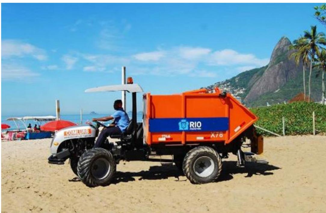
Figura 9 - Trator Agrícola com Reboque para Coleta Urbana de Lixo
