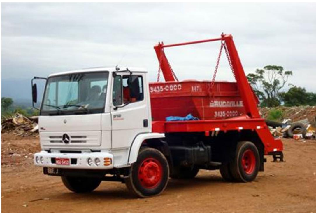
Figura 8 - Caminhão Poliguidaste para Coleta Urbana de Lixo
