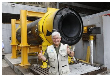
Teste de motor do foguete 100% nacional - "Ensaio de Tiro em Banco do Motor-Foguete S50".
