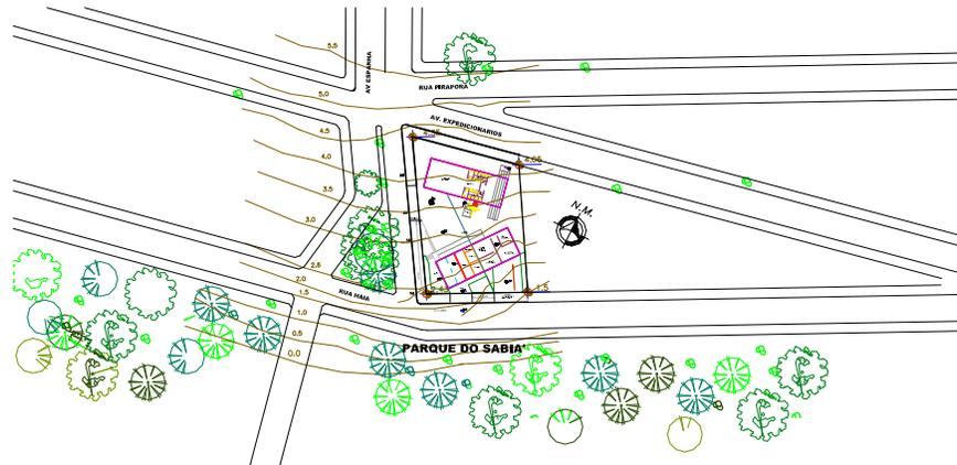
**FIGURA 26** - Exemplo de desenhos feito em CAD 2D (planta baixa com marcações do desnível topográfico do terreno).
