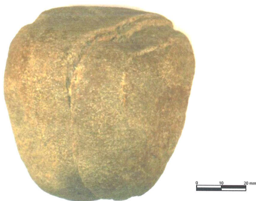
Figura 5.2.2.11 – Detalhe do clasto partido que sofreu deslocamento no plano de fraturamento. Notar que o fraturamento acompanha a incipiente estratificação da rocha da Unidade 2 (Trosdtorf Jr., 2002).
