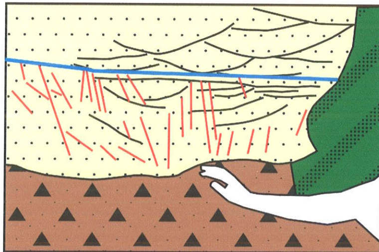
Figura 4.3.10 – Canal de arenito fraturado e falhado, acima do Diamictito 3, na Associação 6 de Jumirim. A) Foto ampla da ocorrência. B) Foto detalhando as estratificações, fraturas e pequenas falhas presentes no retângulo vermelho na foto A. C) Ilustração esquemática da foto B, onde as linhas pretas = estratificações; linhas vermelhas = fraturas e pequenas falhas; área marrom com triângulos = Diamictito 3; área amarela pontilhada = arenito fraturado; área em verde com linhas pontilhadas na diagonal = encoberta; e linha azul = horizonte aplainado adjacente ao lineamento de clastos do PCB.
